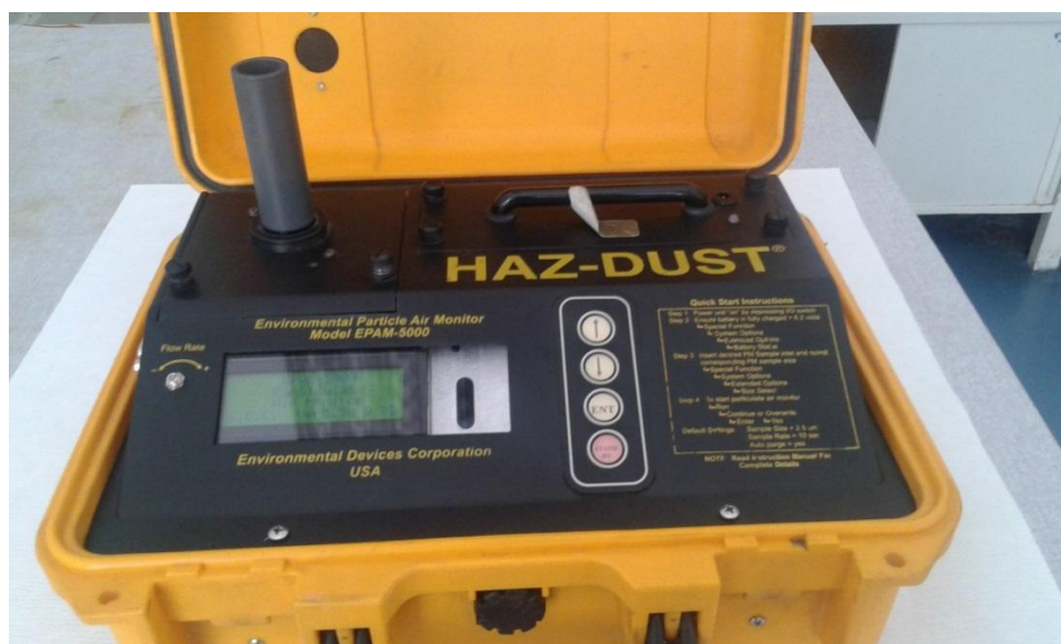
Слика 6. HAZ-DUST EPAM-5000 за узорковање честица
